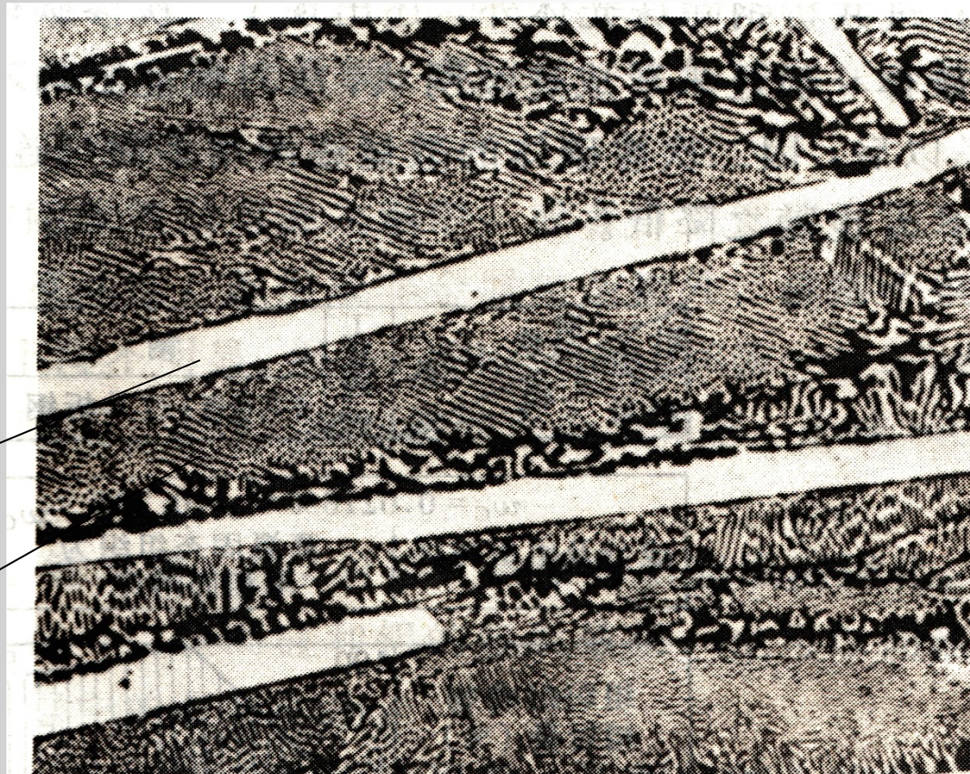
图 5-61 过共晶白口铸铁冷却到室温后的组织(白色条片是一次渗碳体,其余为莱氏体)100×
