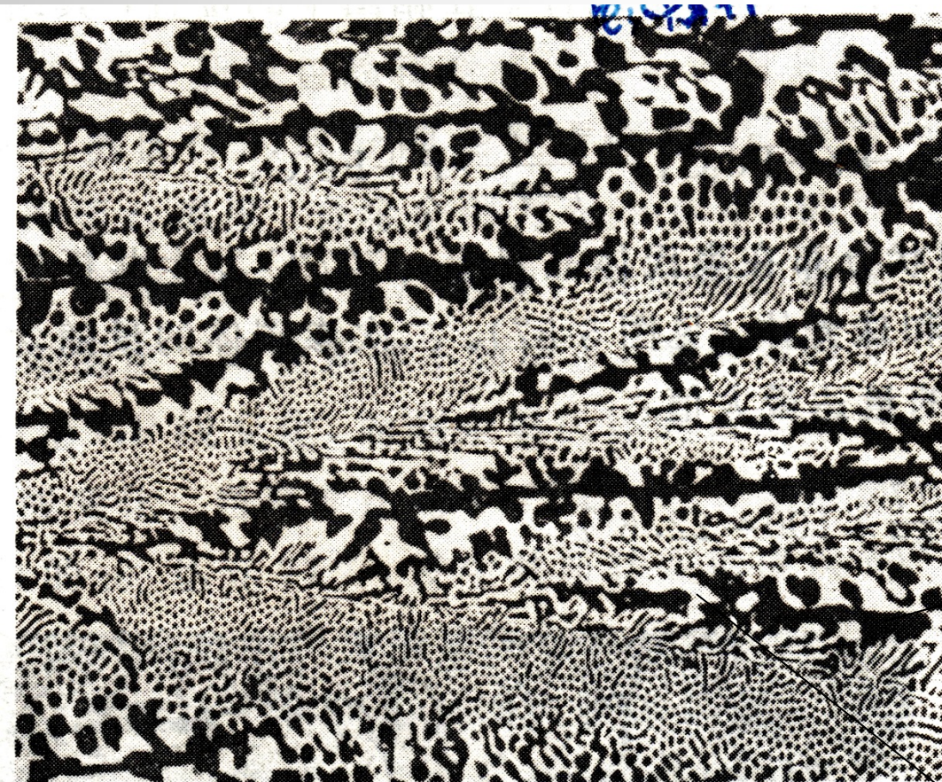
图 5-58 共晶白口铸铁的室温组织（白色基体是共晶渗碳体，黑色颗粒是由共晶奥氏体转变而来的珠光体） 200×
