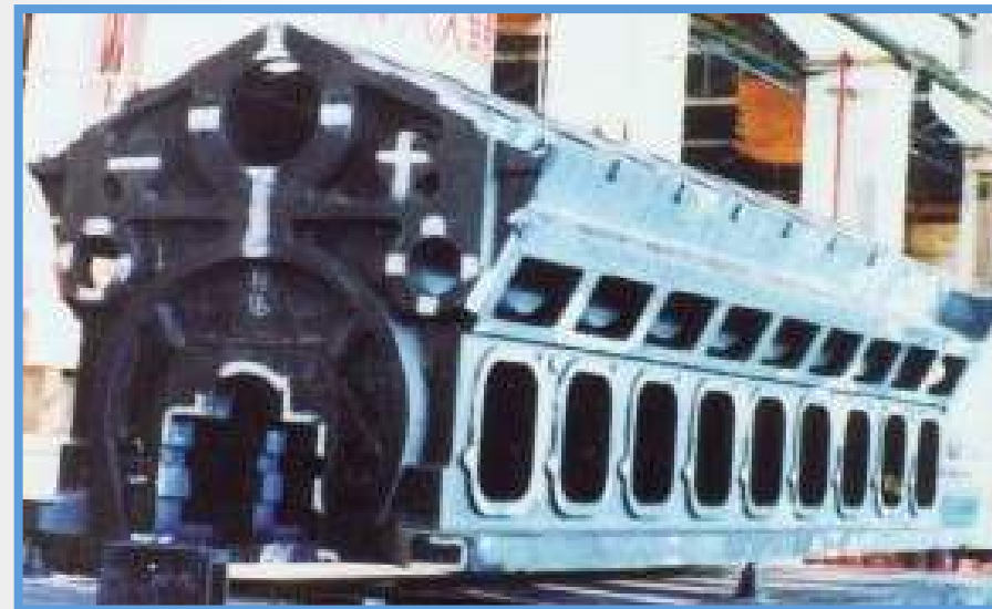
大型船用柴油机汽缸体(HT-300)
